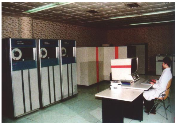
1982 年，福州引进万门程控电话交换系统，同时引进 F-230-38 型电子计算机一套，用于长市话计费。
